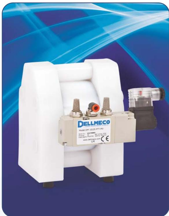
В пластиковых насосах DELLMECO с электромагнитным клапаном для управления направлением подачи сжатого воздуха используются электрические импульсы вместо воздушного распределительного механизма с обратной связью.
